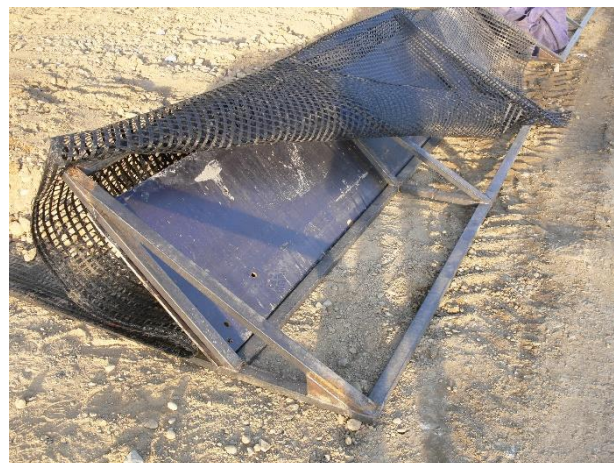
Obr. 48. Posuvné bednění, pohled zepředu
