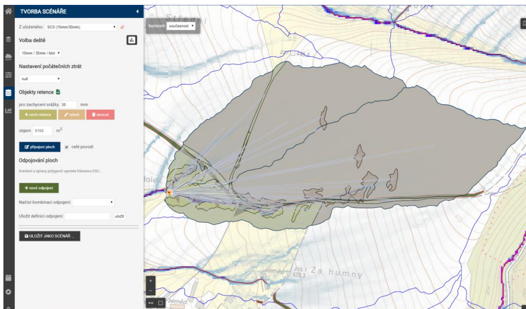
Obr. 11. Ukázka vložení objektu suchého poldru pro odvodnění povodí v extravilánu (šedá barva)
